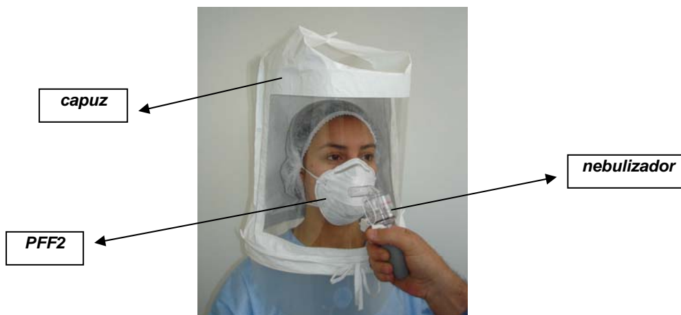
Figura 7: Ensaio de Vedação Facial com sacarina ou Bitrex
